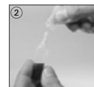
2. Prendre une ampoule contenant l'indicateur CO<sub>2</sub> Special et s'assurer qu'il n'y a pas de liquide indicateur dans le col de l'ampoule ! Sinon, faire descendre l'indicateur en secouant l'ampoule (comme avec un thermomètre médical). Puis ouvrir l'ampoule en tournant le collier de fermeture.
